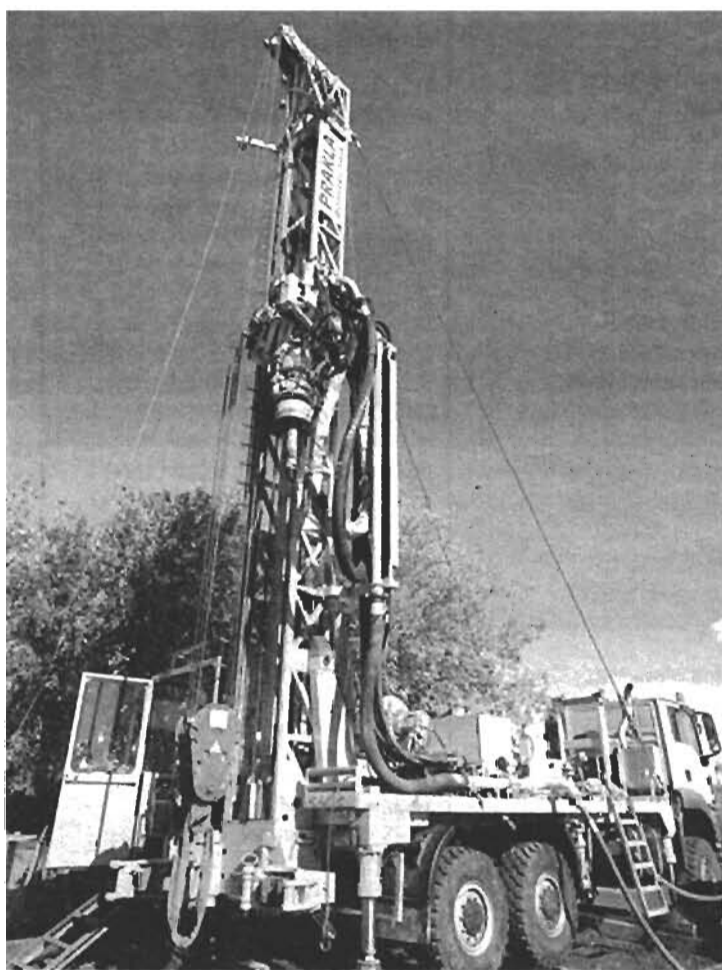
Буровая установка «Prakla RB-50».
