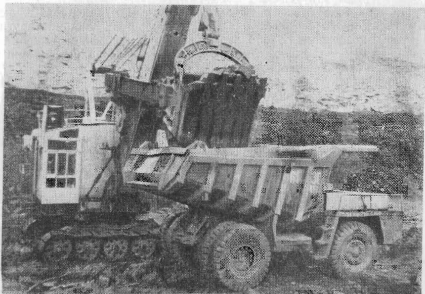
Рис. 7.10. Автосамосвал БелАЗ-540, оборудованный для перевозки угля
