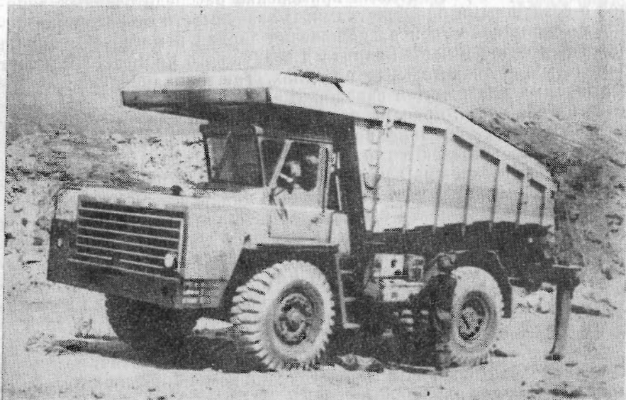
Рис. 66. Зарядная машина МЗ-4 на базе автомобиля БелАЗ-540
