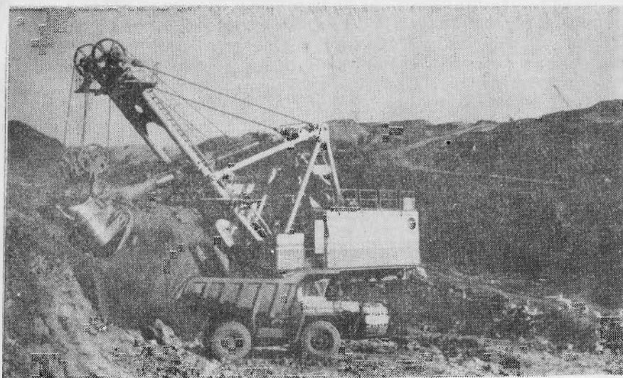
Рис. 3.20. Погрузка породы в автосамосвалы БелАЗ-540 экскаватором ЭКГ-8И
