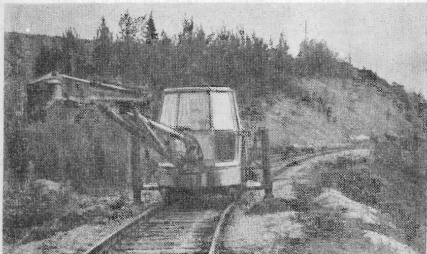
Рис. 7.6. Машина МСУ-3 для механизации вспомогательных работ
